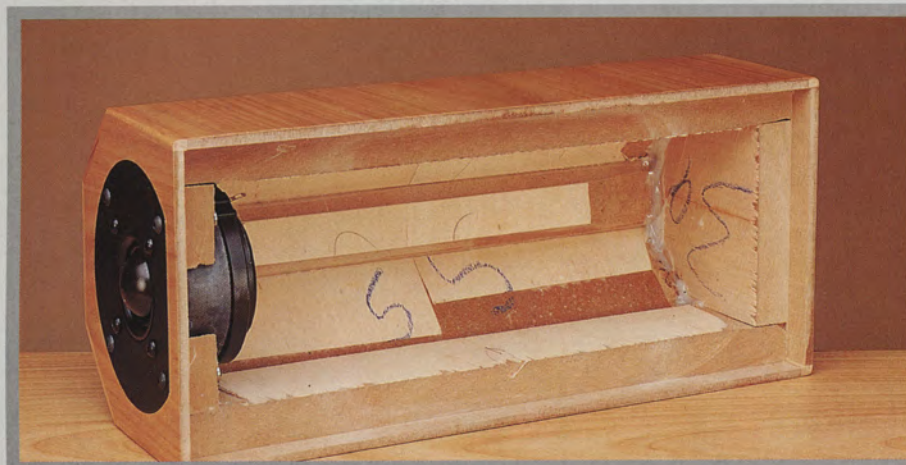
Überzeugte klanglich ungemain: dämpfend gelagerte Hochtoneinheit. Das Chassis von Scanspeak ist mit einer handbeschichteten Gewebekalotte aus Naturseide gefertigt und wiegt ein knappes Kilogramm. Rechts im Bild: Kabel zur Überbrückung der Weiche für späteren Aktivbetrieb
