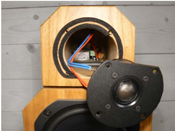
Die Frequenzweiche für die Hochtonabteilung – die zweite Weiche für den Bass-/Mittelton befindet sich im Rumpf direkt hinter dem Anschlussterminal. Zur Verschraubung der Treiber kommen – eigentlich auch selbstverständlich in dieser Preisklasse – metrische Gewinde bzw. Gewindehülsen zum Einsatz.
